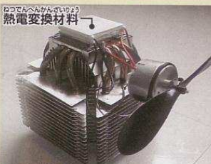
写真提供 慶應義塾大学 武藤研究室 現在、研究中の「温度差発電」の機器。わずか数度の温度差で0.5Wの発電ができる。
