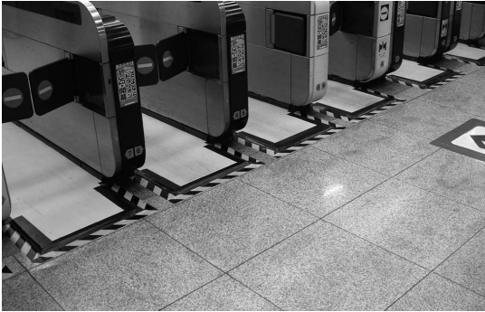
(a) SUICA ゲートでの床発電実験 (2008 年) (a) Power harvesting at SUICA ticket gates in 2008.
