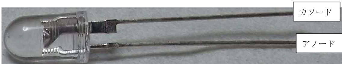
図1.2.12 超高輝度赤色LED (Vf : 2.2V、5 mmサイズ)
